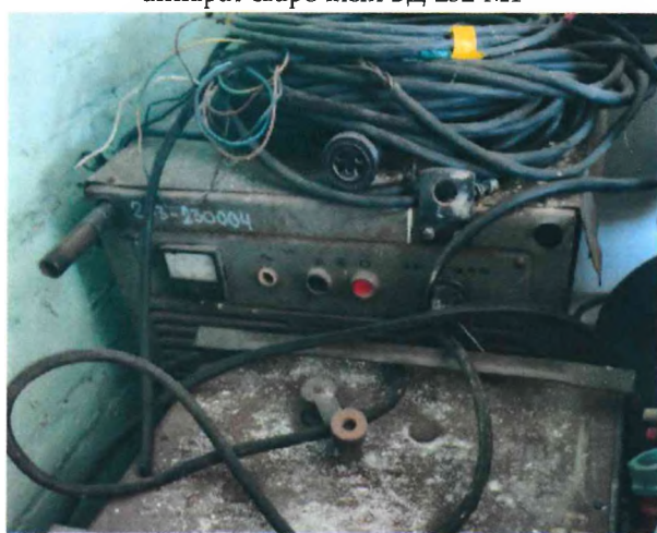
агрегат сварочный ВД-306 з-д N 7697
