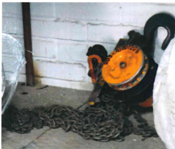
таль ручная г/п 1,0тн в/п 6,0м
